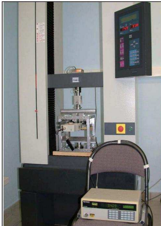
Figures 24 : Dispositif de mise en charge comprenant le banc de flexion 4 points fixé sous la presse électromécanique MTS.
