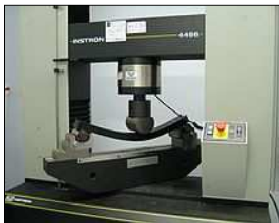
Figure 19 : Illustration d'un test de flexion 3 points
