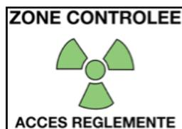
*Figure 15 : Signalétique à afficher à l'entrée des zones à risque de rayonnements ionisants
