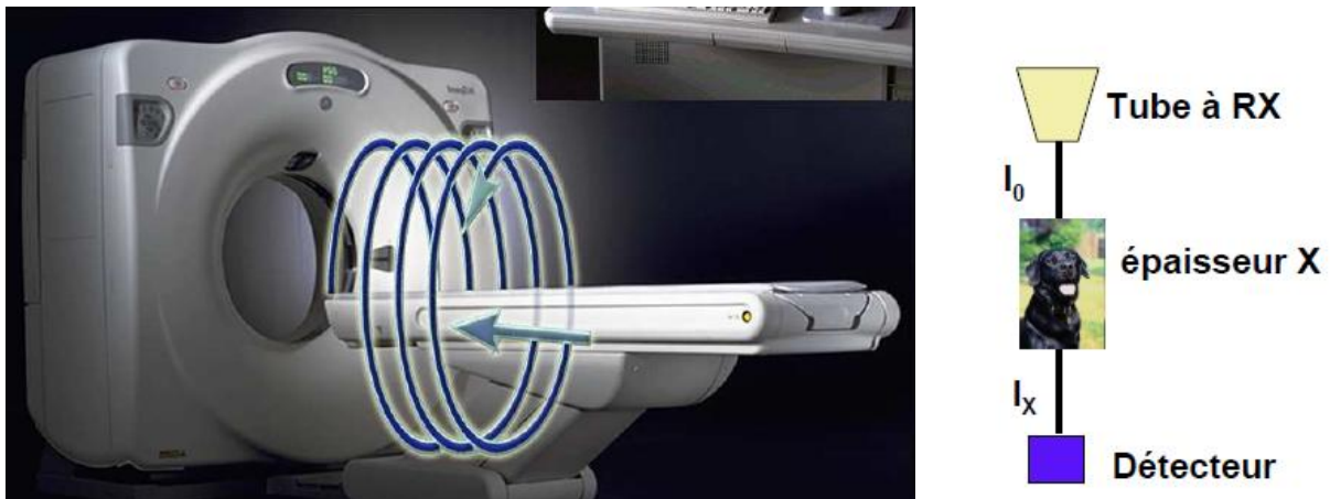
Figure 9 : Acquisition hélicoïdale en TDM : le lit du patient se déplace en continu pendant que le tube tourne et émet ses rayonnements. Les coupes ne sont donc plus acquises les unes après les autres, mais sous la forme d'un "ruban" continu d'images d'un volume de l'organisme d'après [5]
