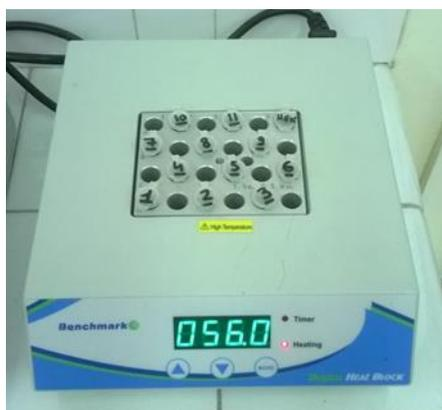
**Photo 10 : Incubation des échantillons sur le bloc chauffant**
