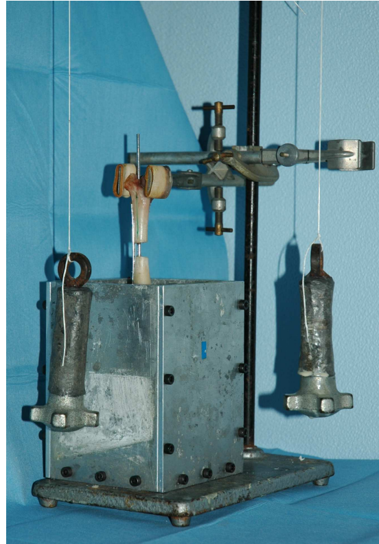
Figure 10: Photographies montrant le bâti sur lequel ont été fixés les fémurs avec un contrôle de la verticalité dans le plan cranio-caudal et médio-latéral.
