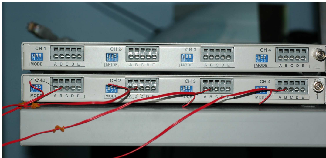
Figure 23: Photographie du pont de jauges lors de l'acquisition des données de déformations des 4 jauges d'extensométrie.
