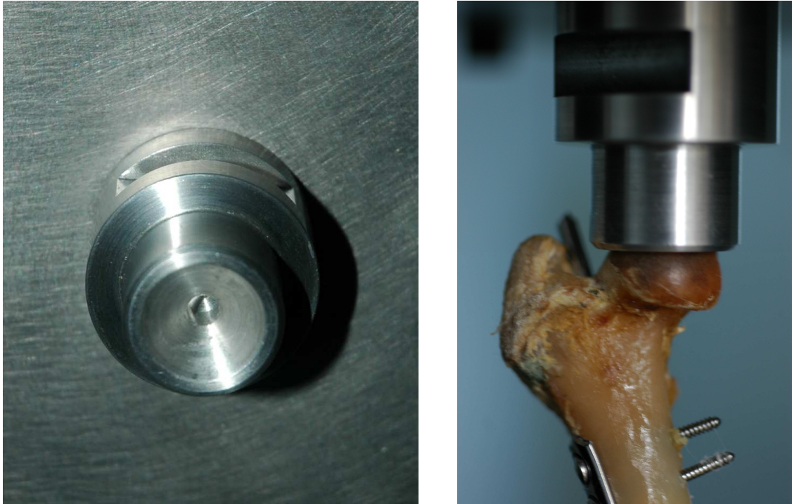
Figure 18: Photographie de la pièce d'adaptation pour appliquer la force de compression sur la tête fémorale.
