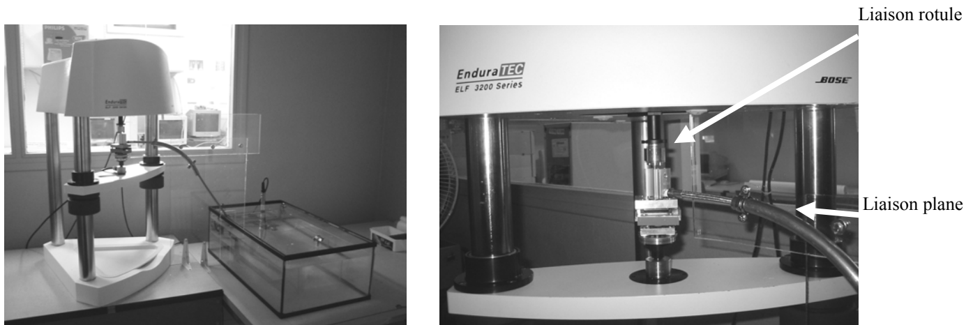
Fig. 27 : Optimisation de la liaison Enduratec®-vérin
