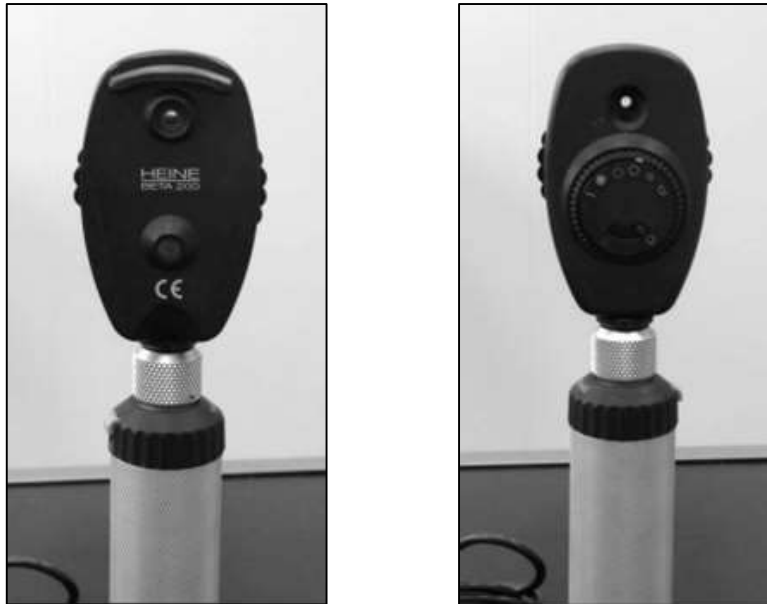
Figure 60 : Ophtalmoscope direct (images de A. REGNIER, ENVT).
