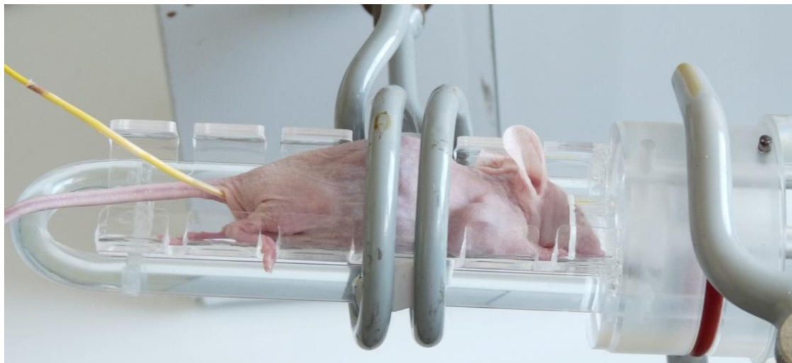
Figure 19 : Bobine électromagnétique et système d'anesthésie permettant l'application du champ magnétique alternatif pour le traitement par hyperthermie des souris porteuses de xénogreffes
