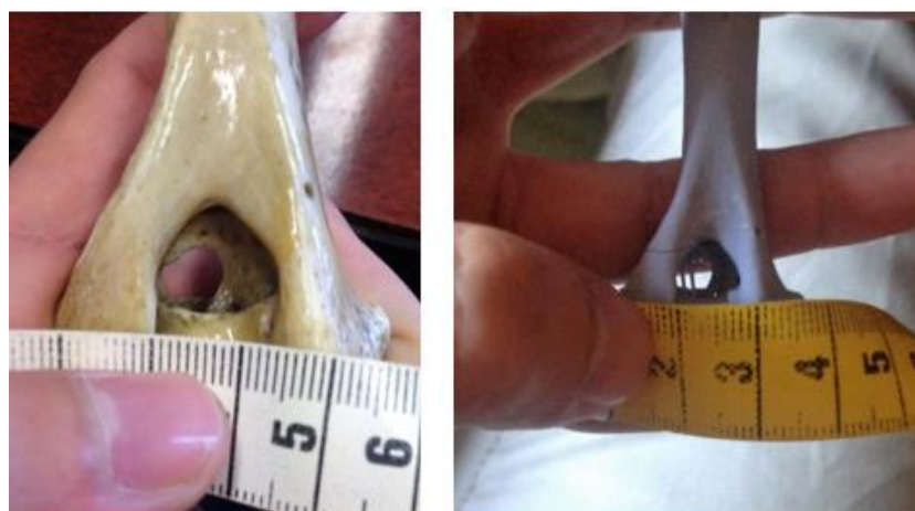
Figure 39 : photographie de la prise de mesure de la largeur de la fosse olécraniennne (à gauche os du musée, à droite os imprimé)
