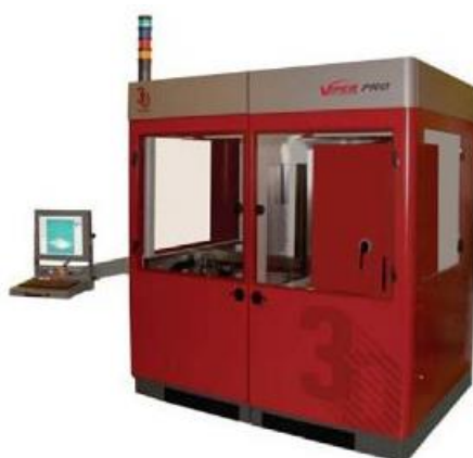
Figure 2 : photographie de l'imprimante "3D Systems' Viper Pro SLA" (extrait de Chua, Leong, Lim 2010)
