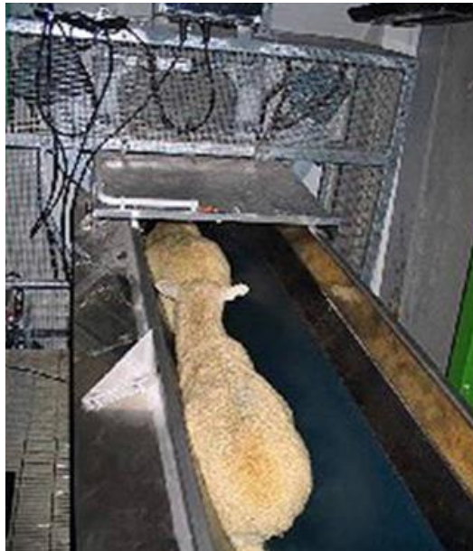
Photographie 6 : Contention des ovins dans un restrainer sur la chaîne d'abattage (36)
