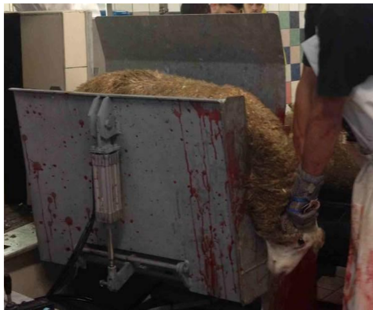
Photographie 7 : Dispositif mécanique destiné à la contention des ovins avant saignée (50)
