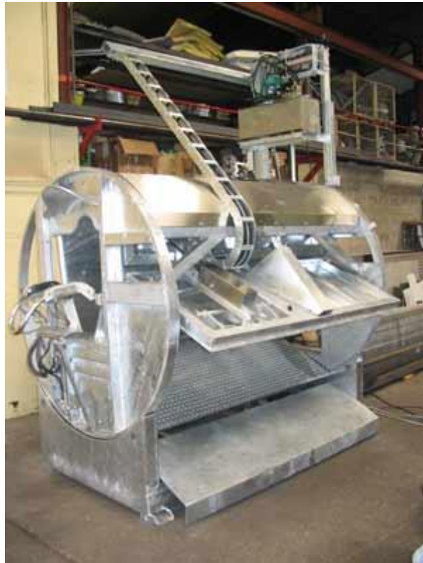
Photographie 4 : Cage à contention utilisée pour les bovins en abattage rituel (49)
