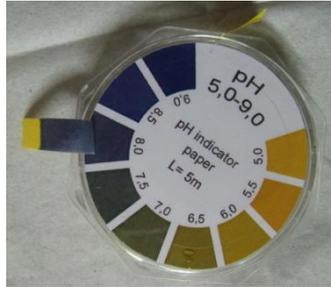
Illustration 24 : Mesure d'un pH urinaire à 8 à l'aide de papier pH de pas 0,5
