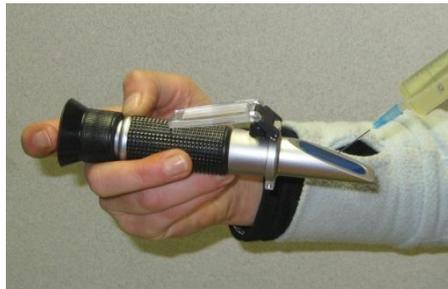
Illustration 25 : Mesure de densité urinaire à l'aide d'un réfractomètre portatif
