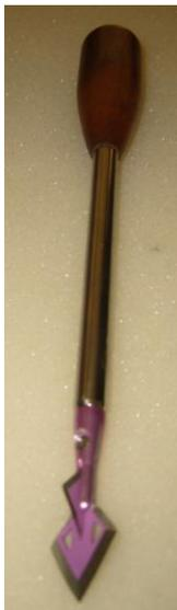
Le trocart est constitué de deux parties vissées entre elles. La première partie est composée d'un manche gris métallique en inox terminé par un manchon bleu pour faciliter la prise en main. La deuxième partie du trocart est formée d'une lance à 3 lames, intégralement constituée en inox de couleur violette. Les deux parties du trocart se séparent facilement en les dévissant
