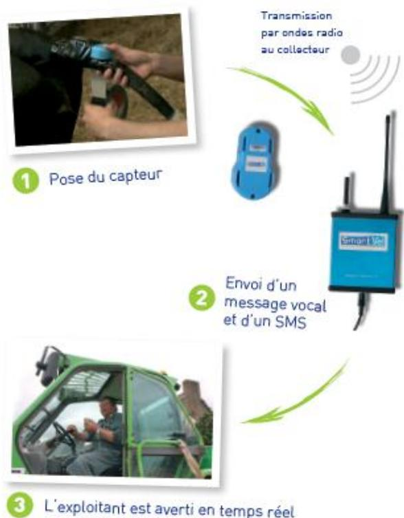
Figure 7 : Principe de la communication depuis l'enregistrement des mouvements de la queue par le capteur jusqu'à l'appel de l'éleveur quelques instants avant le début du vêlage (*source Evolution*)
