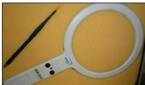
L'activateur permet à l'éleveur d'activer et d'éteindre la sonde à tout moment. Il suffit de positionner la télécommande au-dessus de la région vulvaire et d'appuyer sur on/off afin d'allumer/éteindre la sonde. L'éleveur l'active une semaine à 10 jours avant la date prévue du vêlage. Il l'éteint 24 à 48h après le vêlage.
