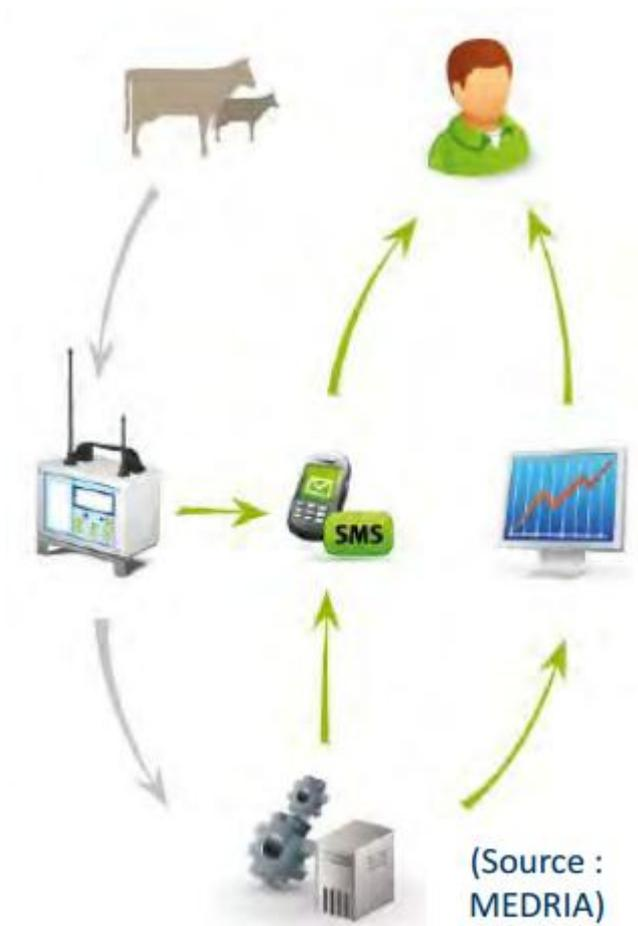
Figure 5 : Illustrations des transferts de données depuis la mesure de la température vaginale par les sondes jusqu'à leur réception par l'éleveur
