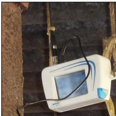
Figure 13 : Station GSM installée dans un élevage, elle reçoit les informations enregistrées par la sonde et les transmet à la société « Happy Foaling »
