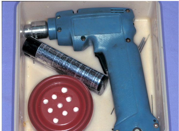
Figure 21 : Perceuse en place pour la stérilisation par le formol ; les pastilles sont dans la boîte percée
