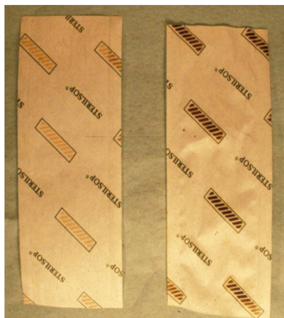
Figure 23 : Indicateurs de stérilisation sur une gaine pour autoclave ; à droite, avant stérilisation, à gauche, après stérilisation
