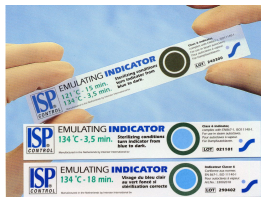
Figure 26 : Intégrateurs papier : noir, après stérilisation, bleu, avant stérilisation
