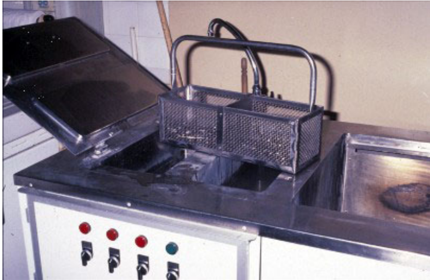
Figure 4 : Bacs à ultrasons de bloc opératoire, avec bain de décontamination, bain de rinçage et bac de séchage
