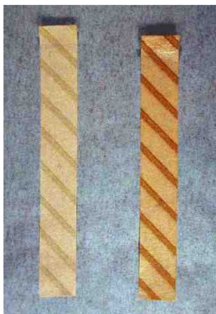
Figure 22 : Rubans indicateurs utilisables en chaleur sèche : à gauche, avant stérilisation, à droite, après stérilisation
