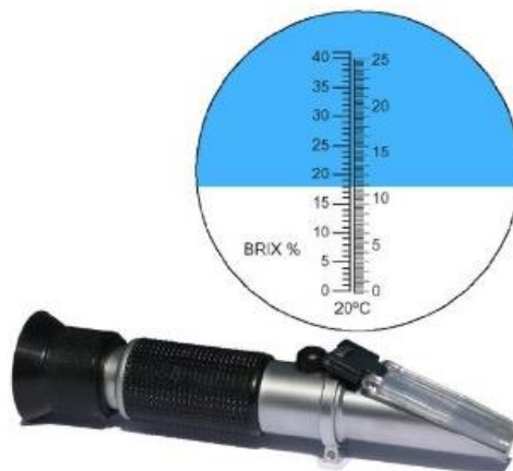
Figure 8 : Réfractomètre optique utilisé et échelle de mesure (Atago Co. Ltd., Tokyo, Japon ; http://www.agir-crt.com )
