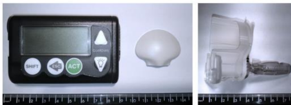
Figure 14 : Système de mesure de glucose en continu Guardian Real-Time® (MEDTRONIC MiniMed, Northridge, USA). De gauche à droite : moniteur, transmetteur à distance, capteur électrochimique (Wiedmeyer et DeClue, 2008).
