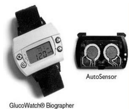
Figure 17 : Appareil de mesure non invasive de la glycémie : GlucoWatch® (GlucoWatch Cygnus Inc., USA, Potts et al., 2002).
