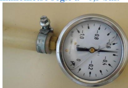
Figure 11 : Photographie du manomètre réglé à - 0,5 bar.
