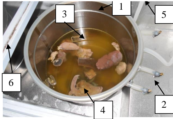
Figure 8 : Photographie de la cuve de silicone et de son contenu pendant la phase d'imprégnation forcée (sans le poids permettant de maintenir les pièces immergées).
