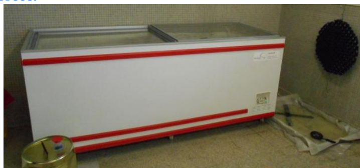
Figure 6 : Photographie du congélateur contenant à la fois les cuves de déshydratation et d'imprégnation forcée.
