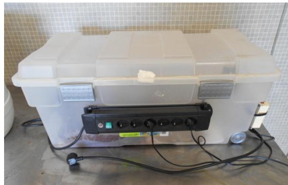
Figure 13 : Photographie du caisson, en vue externe, utilisé lors de la phase de durcissement.
