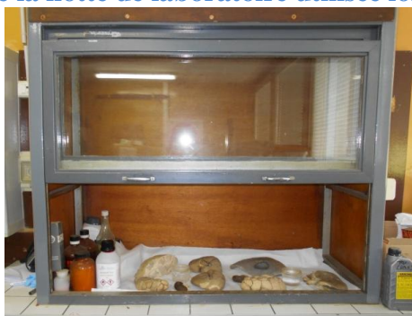
Figure 15 : Photographie de la hotte de laboratoire utilisée lors de la phase de séchage.
