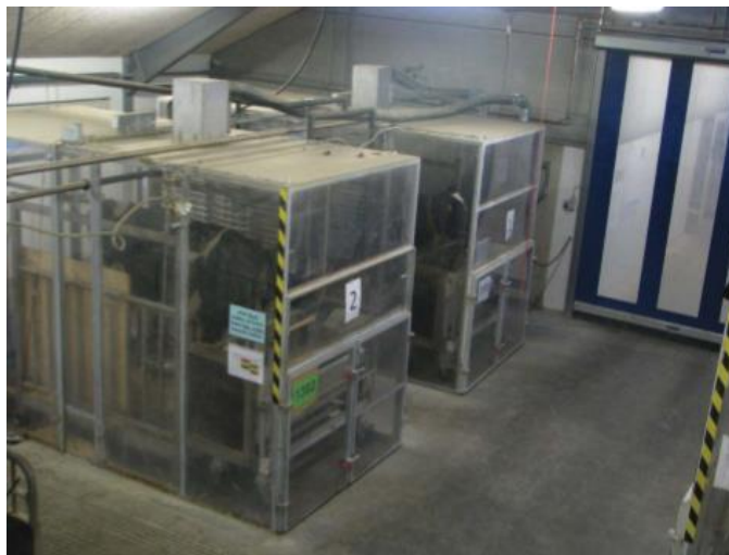
Photographie 1 : Chambres respiratoires avec murs transparents, fabriquées à l'Université d'Aarhus (Danemark) (Storm et al., 2012)
