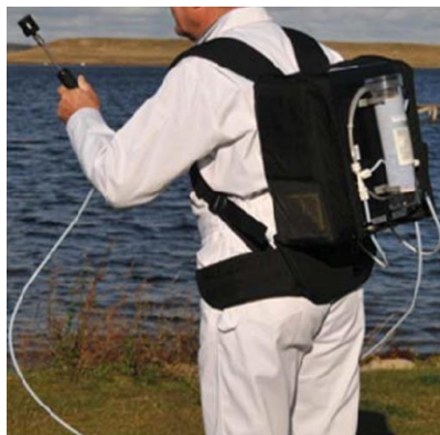
Photographie 2 : Le Gasmét portable (Storm et al., 2012)
