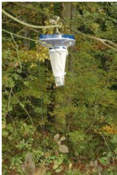
Figure 14: Piège lumineux de type OVI permettant la capture de *Culicoides* (d'après CIRAD).
