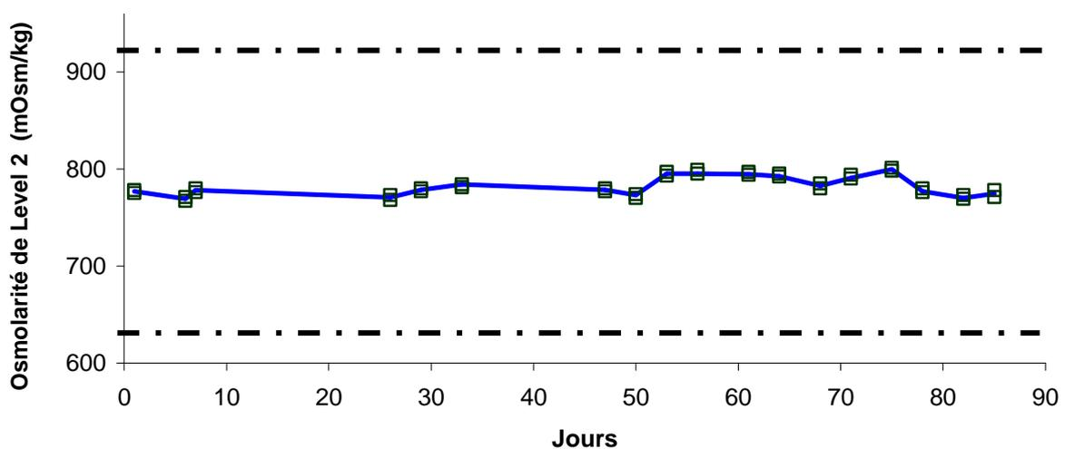
**Figure 4 :** Diagramme de contrôle de qualité de la mesure de l'osmolarité urinaire sur l'échantillon Level 2. Toutes les mesures ont été effectuées deux fois ; la courbe est celle de la moyenne des résultats. Les lignes pointillées représentent les limites d'acceptabilité données par le fabricant.
