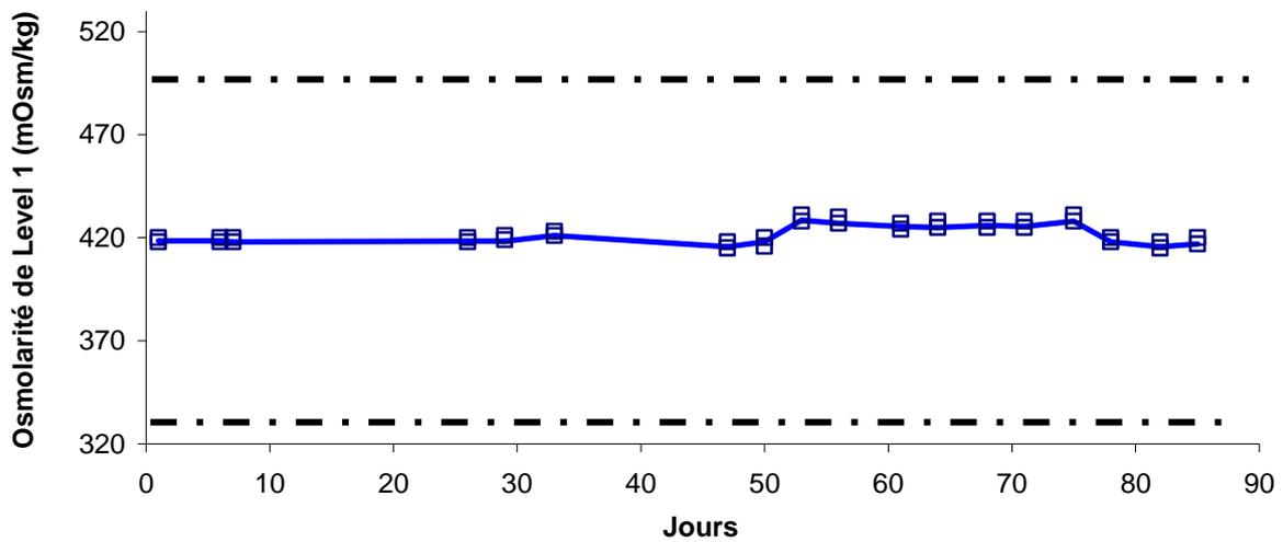
**Figure 3 :** Diagramme de contrôle de qualité de la mesure de l'osmolarité urinaire sur l'échantillon Level 1. Toutes les mesures ont été effectuées deux fois ; la courbe est celle de la moyenne des résultats. Les lignes pointillées représentent les limites d'acceptabilité données par le fabricant.
