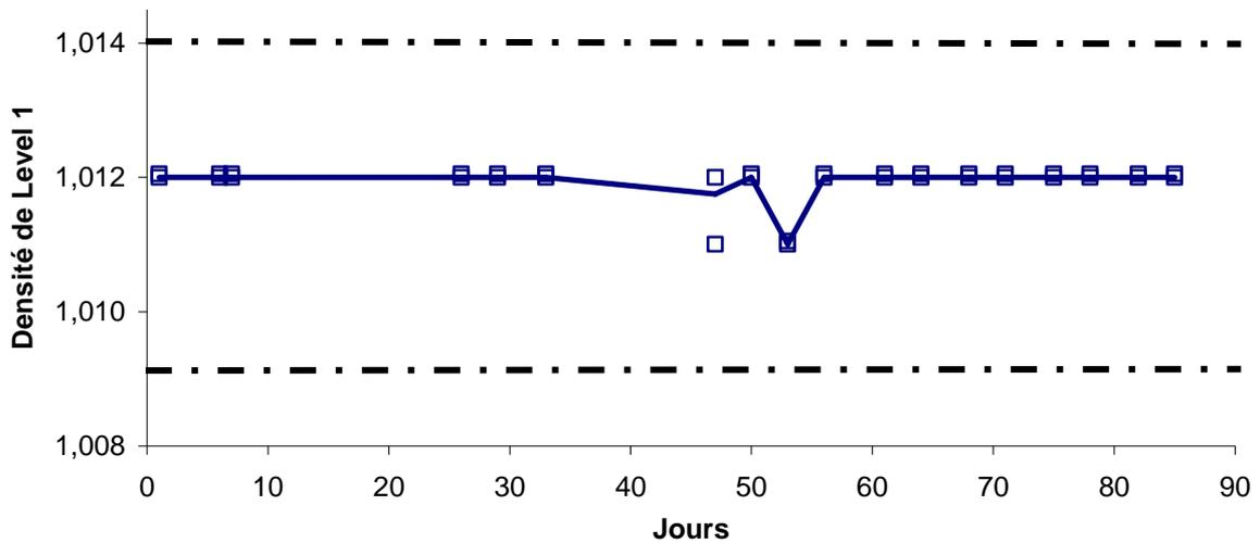
**Figure 5 :** Diagramme de contrôle de qualité de la mesure de la densité de l'échantillon Level 1. Toutes les mesures ont été effectuées deux fois ; la courbe est celle de la moyenne des résultats. Les lignes pointillées représentent les limites d'acceptabilité données par le fabricant.
