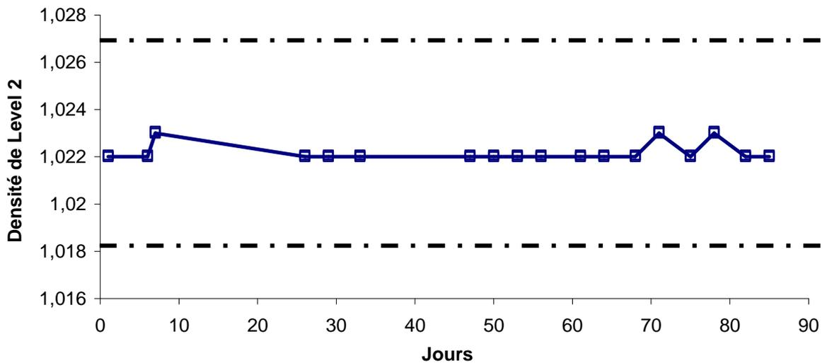
**Figure 6 :** Diagramme de contrôle de qualité de la mesure de la densité de l'échantillon Level 2. Toutes les mesures ont été effectuées deux fois ; la courbe est celle de la moyenne des résultats. Les lignes pointillées représentent les limites d'acceptabilité données par le fabricant.
