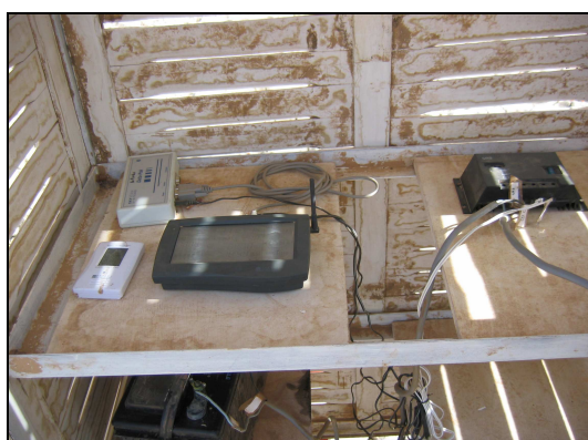
Photo 15 : pluviographe numérique à l'intérieur d'une station météorologique (Greboval M).
