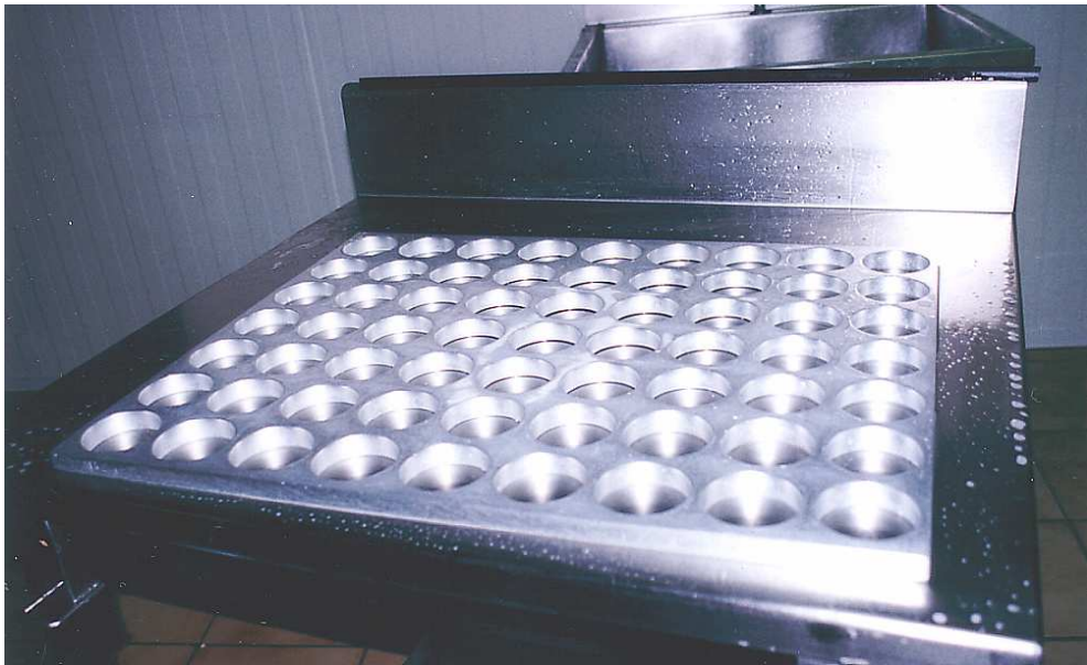
Figure n°11 – Photographie d'une plaque multi-moules en inox servant au moulage du caillé
