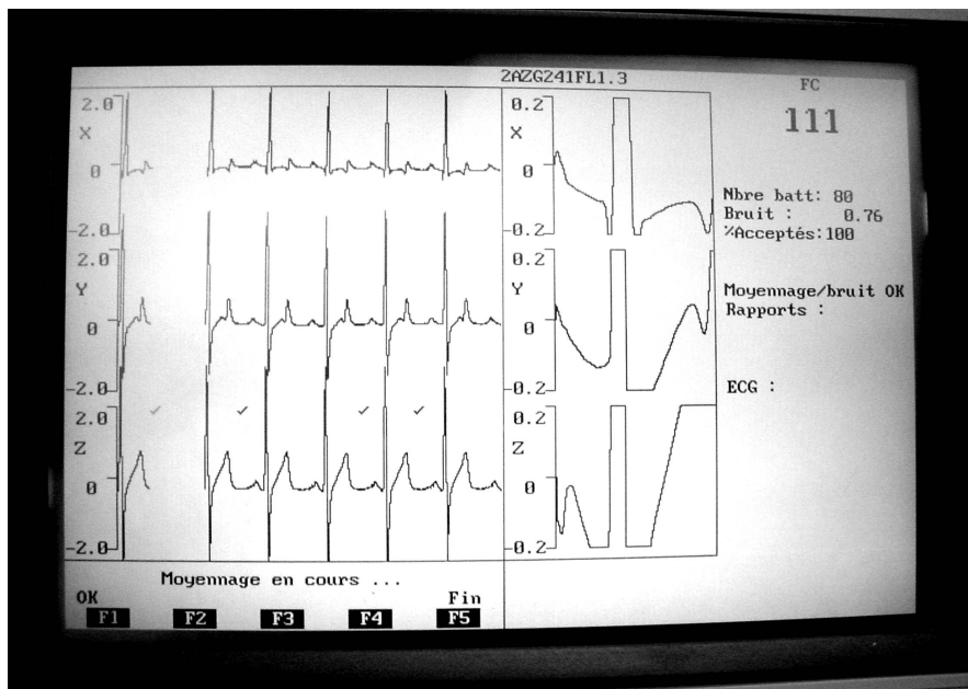
Photographie 6 : Moyennage automatique des battements cardiaques (étape 2) les complexes retenus sont marqués par l'appareil avec γ affichage de la fréquence cardiaque, du nombre de battements et du bruit
