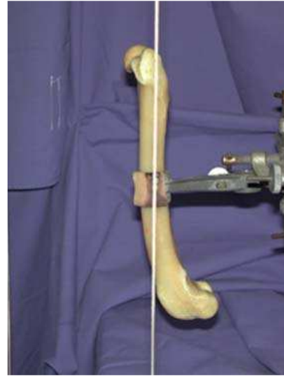
Photo 13 : Verticalisation des fémurs dans le plan médio-latéral.
