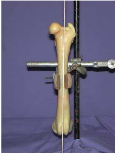
Photo 12: Verticalisation des fémurs dans le plan crânio-caudal.
