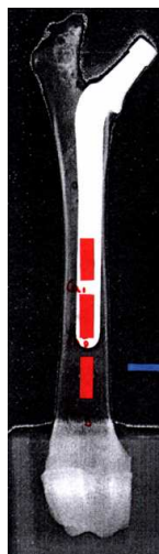
Annexe 31 : Déformation caudale du témur pour la prothèse Amplitude de taille 7, enregistrées par jauges d'extensométrie. Les valeurs à gauche sont les valeurs des déformations lors de mise en charge maximale.
