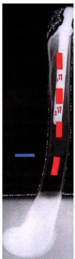
Annexe 12 : Déformation latérale du fémur pour la prothèse Amplitude de taille 2, enregistrées par jauges d'extensométrie. Les valeurs à gauche sont les valeurs des déformations lors de mise en charge maximale.
