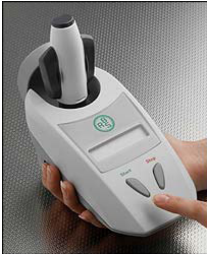
Figure 10 : Analyseur d'échantillon de souffle (Mikota, 2007, [76])
