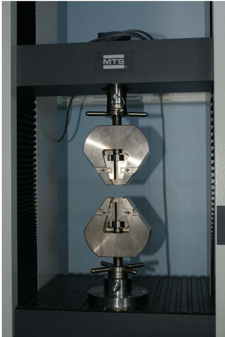
Photo 13 : Presse électromécanique MTS 10/MH ®
