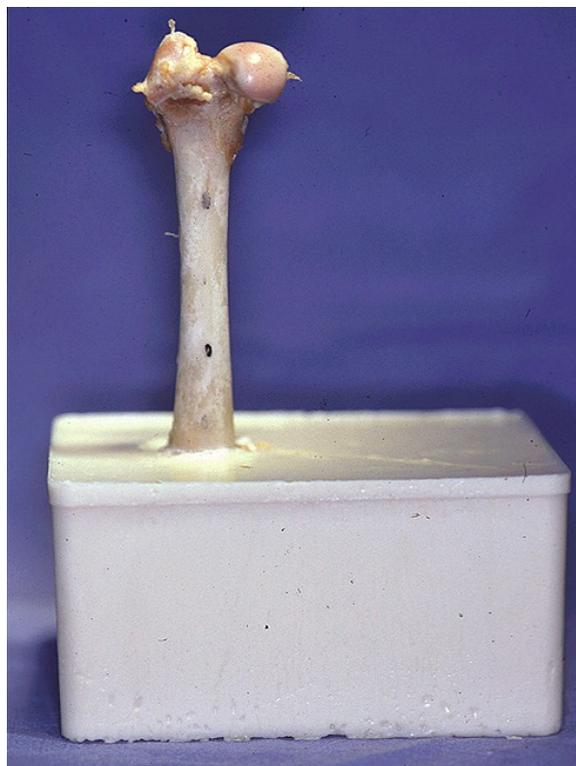
**Figure 4 :** photographie montrant un fémur inclus dans un socle de résine
