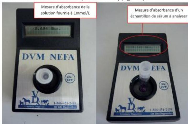
FIGURE 2 EXEMPLE DE MESURES DE L'ABSORBANCE AVEC LE DVM NEFA : SUR LA SOLUTION DONT LA CONCENTRATION EST CONNUE (PHOTO À GAUCHE) ET SUR UN DES ÉCHANTILLONS (PHOTO À DROITE) (G. FORGEAT)
