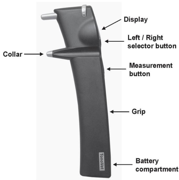
Figure 3 : Tonovet®, méthode de tonométrie à rebond pour la mesure de la PIO (Knollinger 2005)
