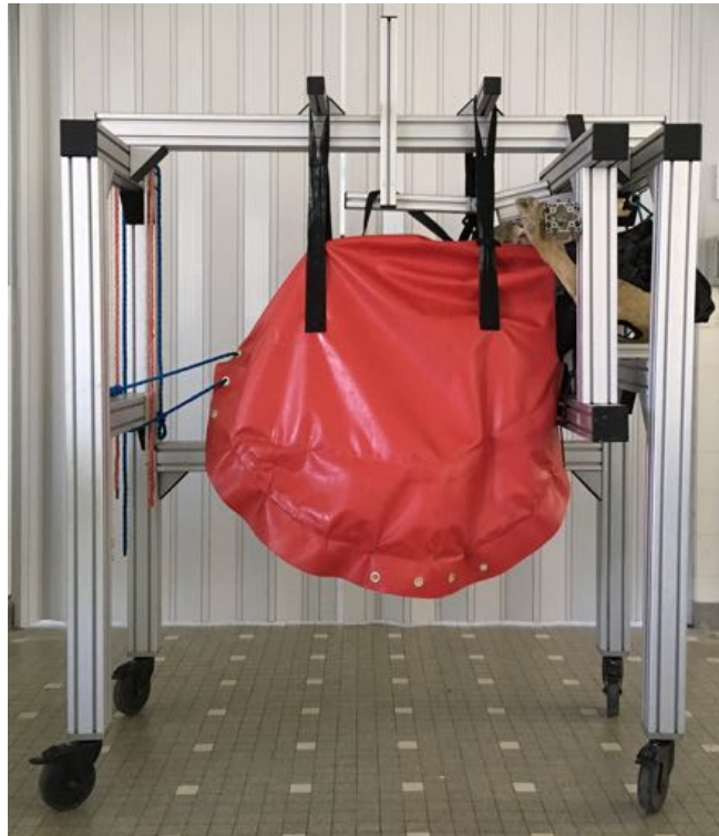
Figure 6 : Simulateur de vêlage réalisé par le service de reproduction de l'ENVT
