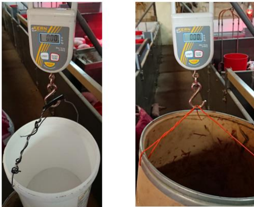
Figure 7 : Photographie du système de pesée des porcelets au sevrage et cinq jours après
