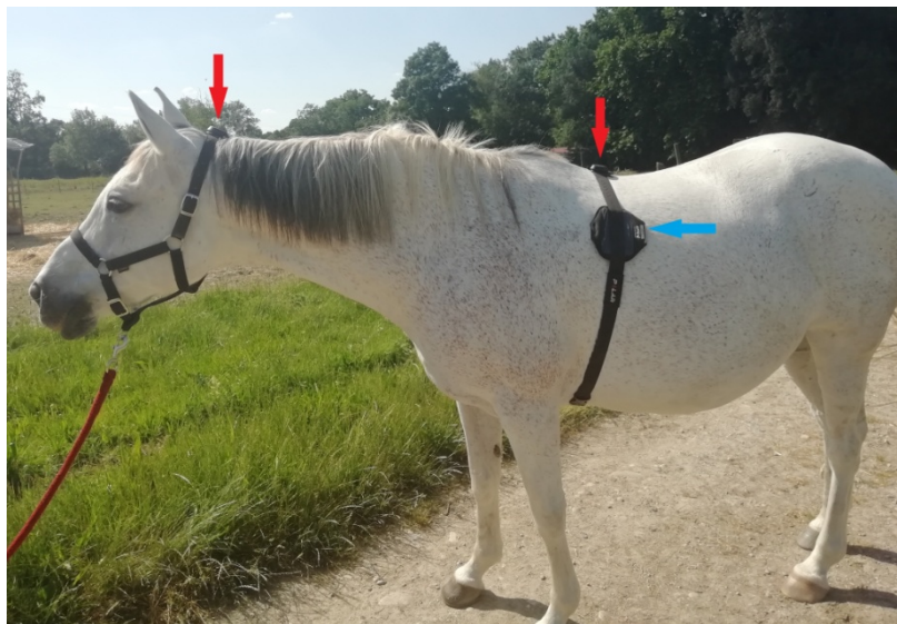
Figure 15 : Dispositif accélérométrique mis en place. Composé par les capteurs (flèches rouge) et la sangle permettant l'embarquement du téléphone (flèche bleu).
