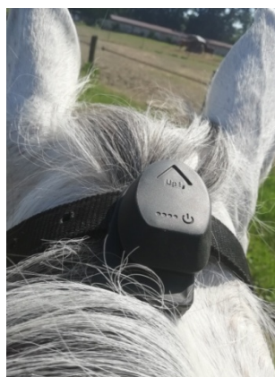
Figure 14 : Capteur tête mis en place, couvert par une protection.
