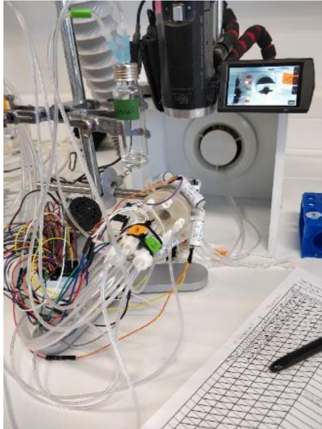
Figure 16 : dispositif d'entraînement et de test. Au premier plan l'ordinateur avec les circuits menant aux deux odeurs (une des deux fioles visibles avec l'étiquette verte), au milieu du dispositif l'abeille en harnais puis en fond l'extracteur d'air. Le tout enregistré en vidéo par la caméra
