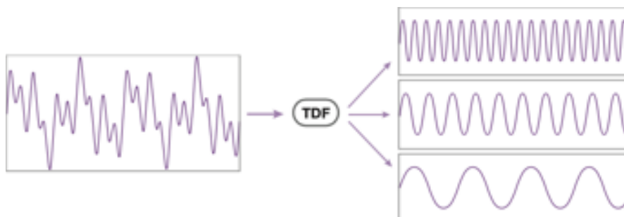
Figure 53 : Décomposition d'un signal quelconque par la transformée de Fourier (50)
