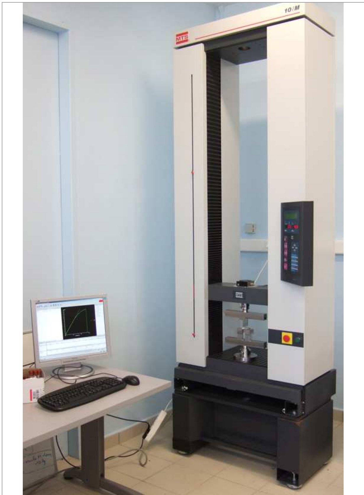
Figure 15 : Presse électromécanique 10MH-MTS et logiciel TestWork 4.8.
