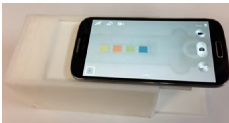
Figure 25: Utilisation d'un système en plexiglass® blanc avec emplacement pour la caméra du smartphone (Jalal et al. 2017).
