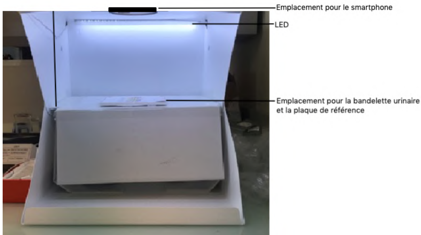
Figure 36 : Dispositif permettant de maintenir une distance et une luminosité constante pour assurer la reproductibilité des expériences.
