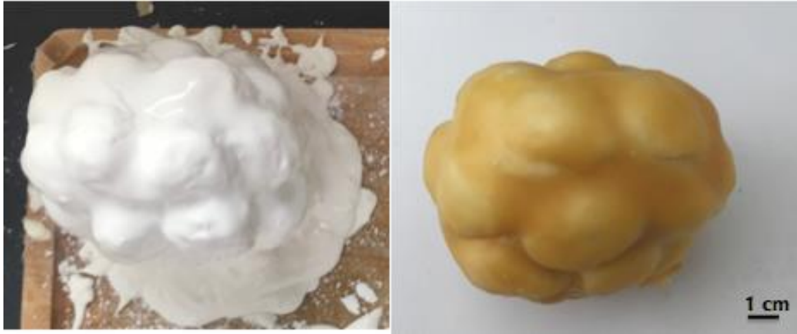
Fig. 32 : Fabrication du rein gauche Phase de séchage vue de dessus (à gauche) et modèle de rein gauche finalisé vue de dessus (à droite)
