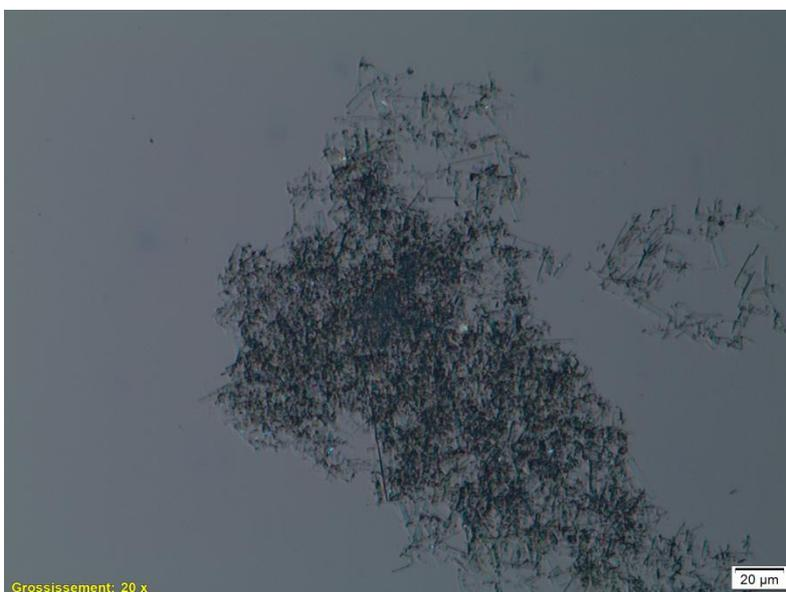
Figure 56 : Observation d'un amas de gélifiant G3 sec de concentration massique de 1% formé à 100 µl/min
