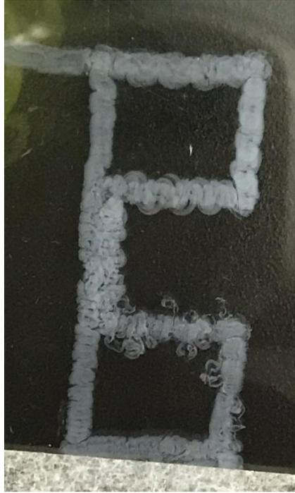
Figure 76 : Photographie de la figure en 2 couches réalisée avec une vitesse d'impression de 4 mm/s, une vitesse d'extrusion de 20  $\mu$ l/min et une aiguille de 30G
