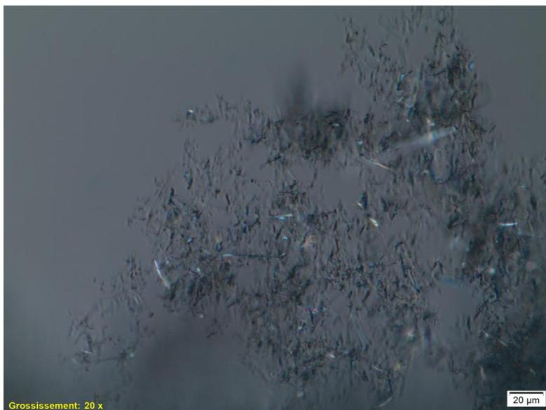
Figure 55 : Observation d'un amas de gélifiant G3 sec de concentration massique de 1% formé à 50 µl/min
