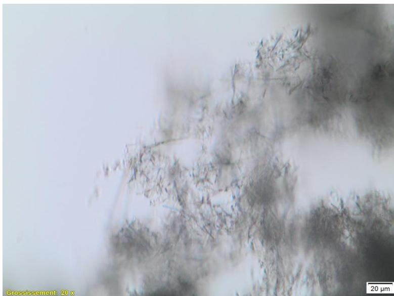
Figure 58 : Observation d'un filament de gélifiant G3 humide de concentration massique de 3% formé à 100  $\mu\text{l}/\text{min}$
