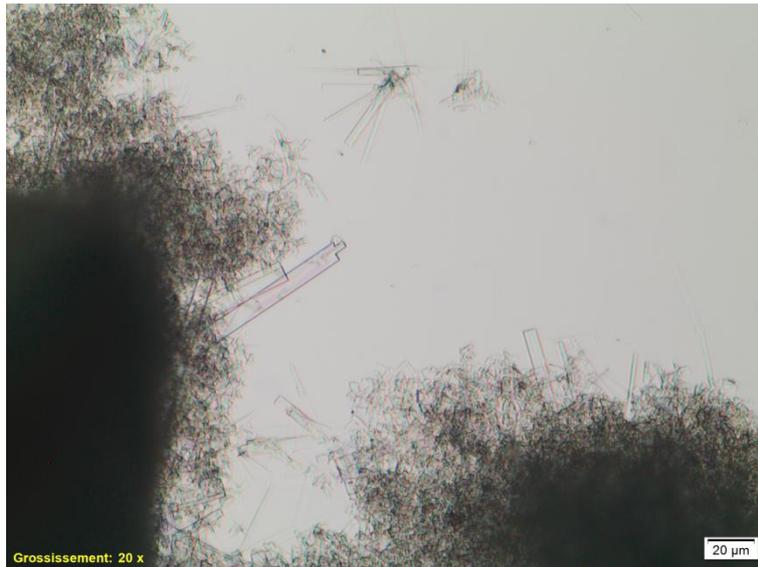
Figure 57 : Observation d'un filament de gélifiant G3 sec de concentration massique de 3% formé à 50  $\mu\text{l}/\text{min}$
