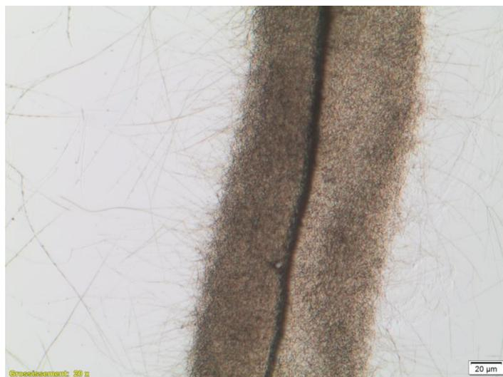
Figure 67 : Observation d'un filament de gélifiant G2 de concentration massique de 4% formé à 10  $\mu\text{l}/\text{min}$ , suite à 24h de séchage après formation
