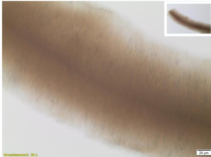
Figure 66 : Observation d'un filament de gélifiant G2 de concentration massique de 5% formé à 50  $\mu\text{l}/\text{min}$ , humide, après formation
