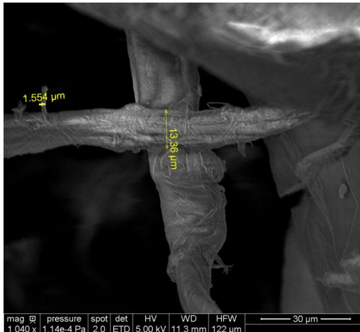
Figure 61 : Observation d'un filament de géliifiant G3 de concentration 2% extrudé à 40  $\mu\text{l}/\text{min}$  au MEB
