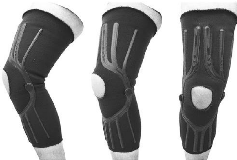
Figure 15 : Dispositif orthopédique personnalisé imprimé en 3D et renforcé de fibres courtes de carbone directement sur un tissu textile tricoté. (Source : Ahrendt, Romero Karam 2020)
