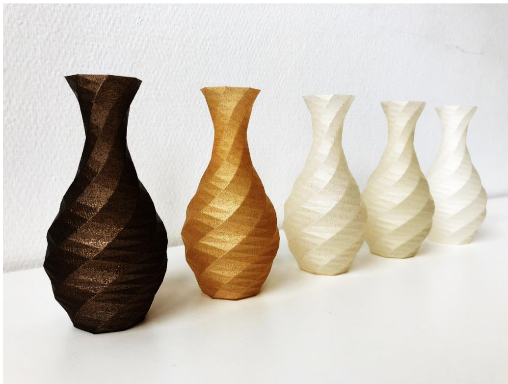
Figure 14 : Vases imprimés avec des filaments biocomposites. De gauche à droite : PLA café, PLA blé, PLA huître, PLA moule et PLA coquille Saint-Jacques. (Source: www.francofil.fr )
