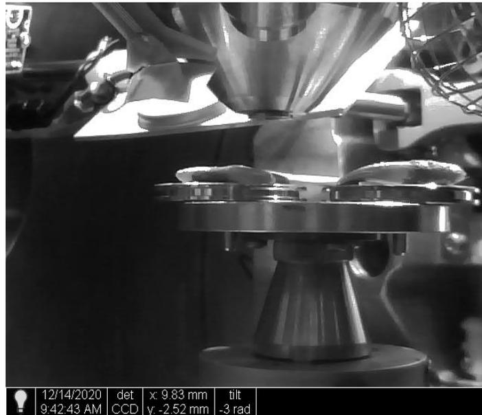
**Figure 69 : chambre d'observation vue latéralement, on y voit l'objectif du microscope ainsi que les échantillons déposés sur les plots métalliques**
