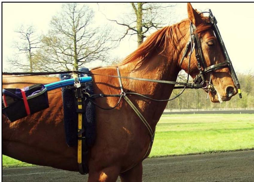
**Figure 24** : Cheval équipé du microphone, relié au boîtier enregistreur sur le brancard du sulky.
