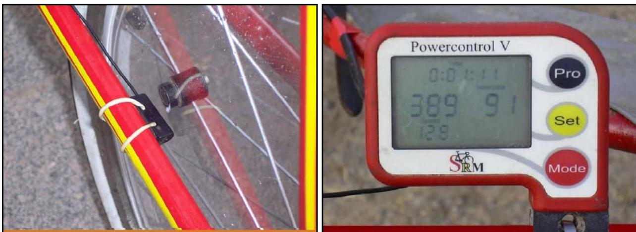
**Figure 19** : Aimant du tachymètre fixé à la roue du sulky (photo gauche) et écran du tachymètre fixé sur le sulky de façon à être visible par le driver (photo droite).
