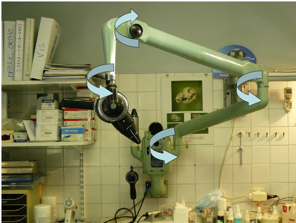
Photo 2 : mouvements possibles grâce au bras articulé de l'appareil à rayon X spécifiquement dentaire (Philips Oralix)
