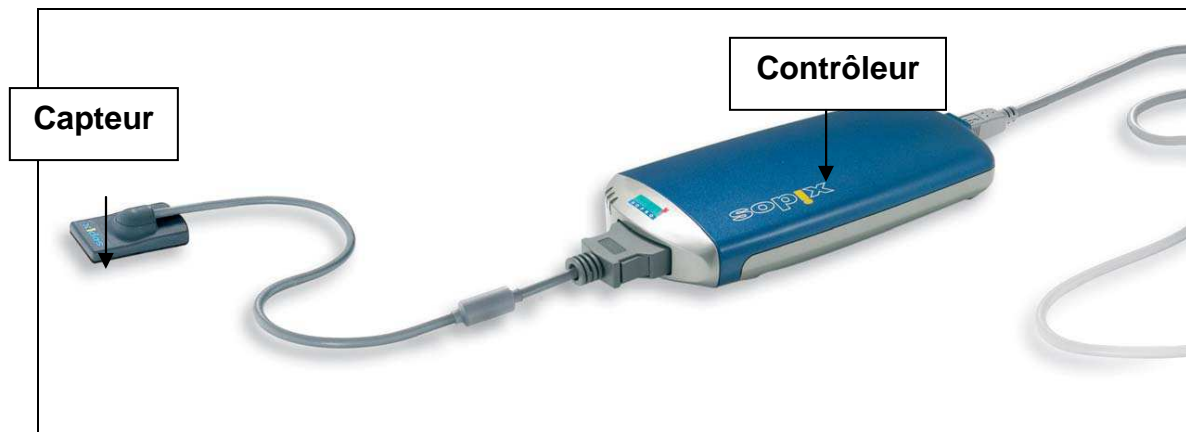
Photo 15 : capteur Sopix USB et son contrôleur (Sopro – La Ciotat)
