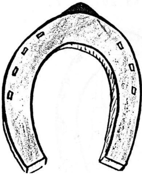
Figure 54a: Schéma d'un fer plat avec pinçon en pince. 26
