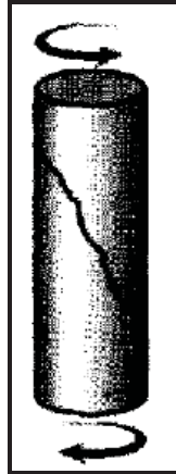
Figure 5: Illustration montrant la morphologie de la fracture produite par des forces en torsion, la ligne de fracture est en spirale [2].
