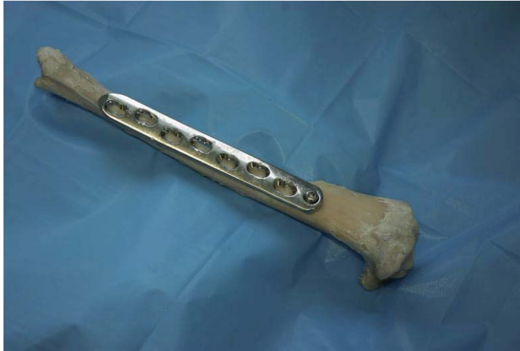
Figure 26 : Insertion de la première vis dans le trou n°1 sur le tibia 12G
