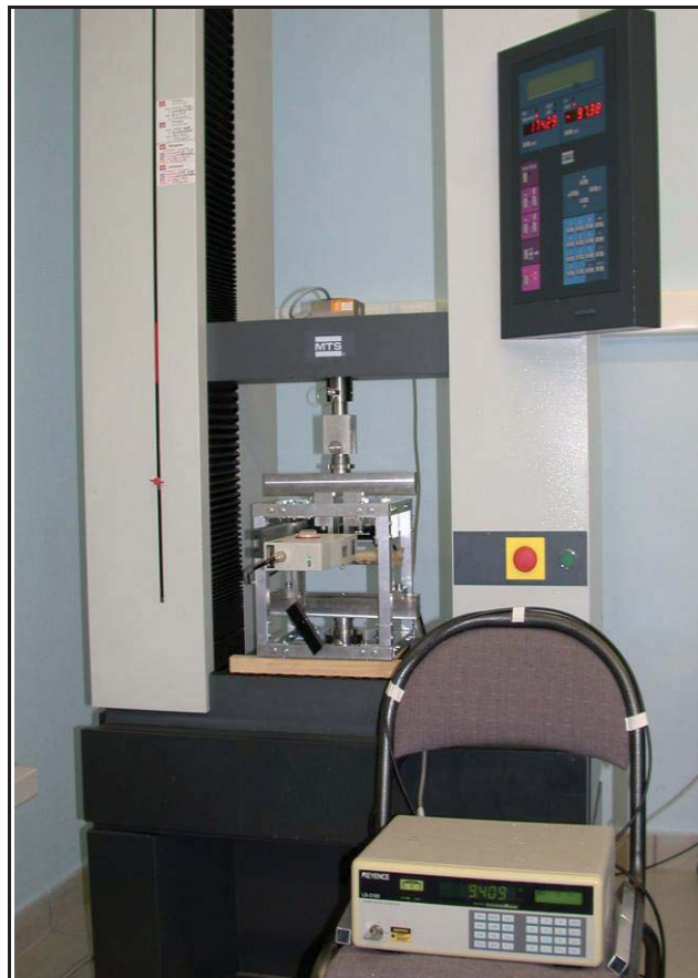
Figures 33 : Dispositif de mise en charge comprenant le banc de flexion 4 points fixé sous la presse électromécanique MTS.
