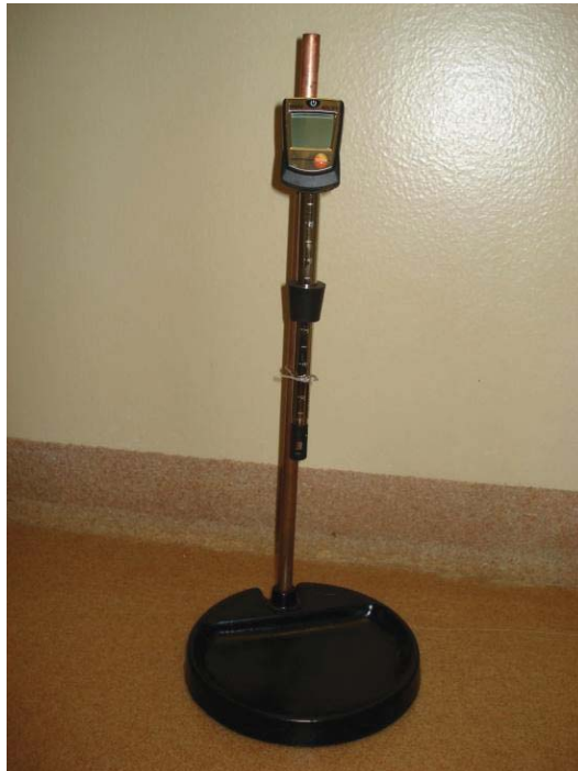
Photo 10 : Anémomètre fixé sur son support
