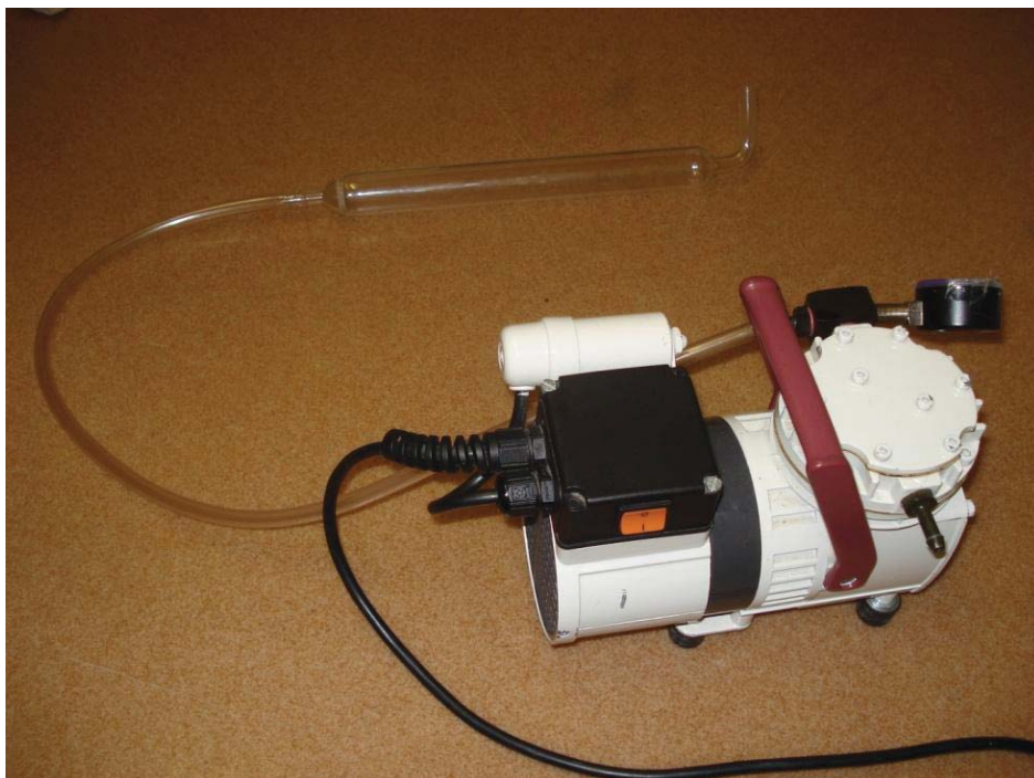
Photo 11 : Tube d'aspiration relié à une pompe
