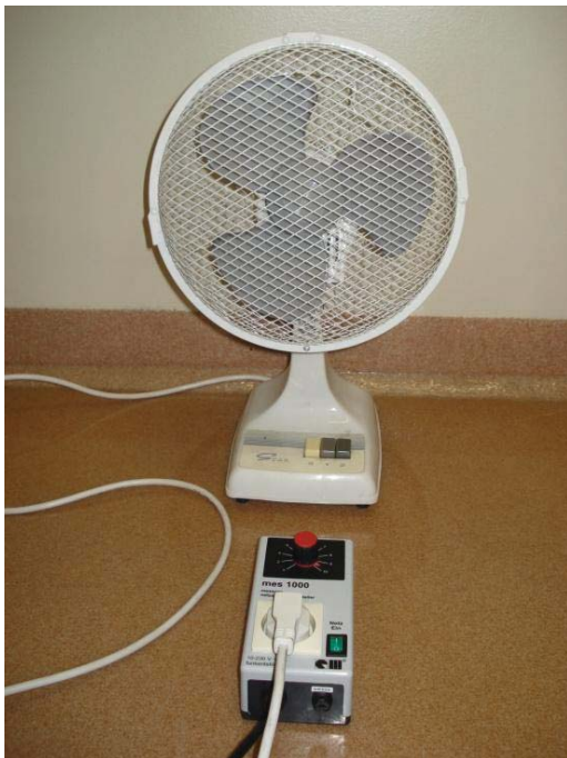
Photos 8 et 9 : Les deux modèles de ventilateur utilisés reliés au variateur : le petit à gauche, le grand à droite.
