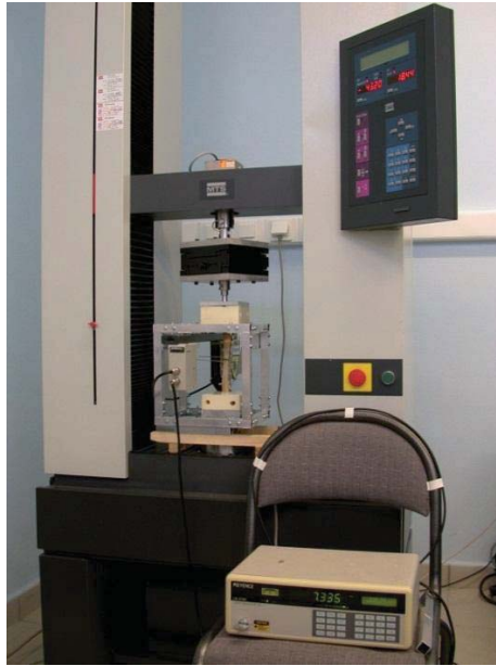
Figures 32 : Dispositif de mise en compression axiale. L'os n°14 est placé sous la presse électro-mécanique. Un dispositif de tables croisées dynamiques est placé entre l'os testé et la traverse.
