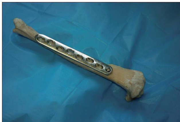
Figure 23 : Insertion de la première vis dans le trou n°1 sur le tibia 12 G
