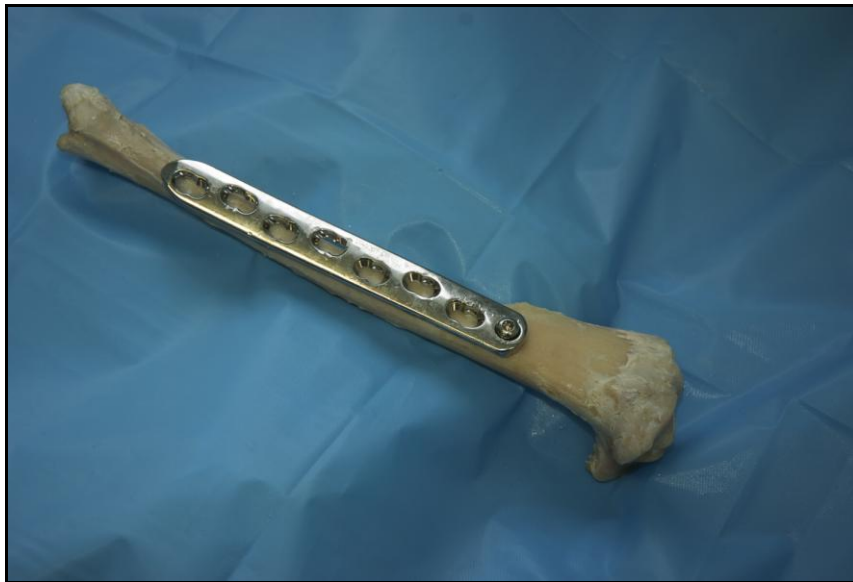
Figure 27 : Insertion de la première vis dans le trou n°1 sur le tibia 12G
