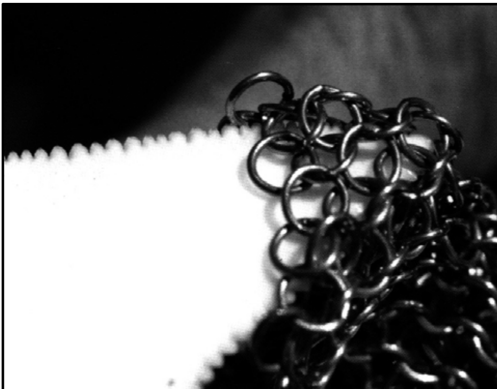
67- Ill .6 : la combinaison Neptunic : dent d'un Grand Blanc et anneaux en acier de la Neptunic [114]
