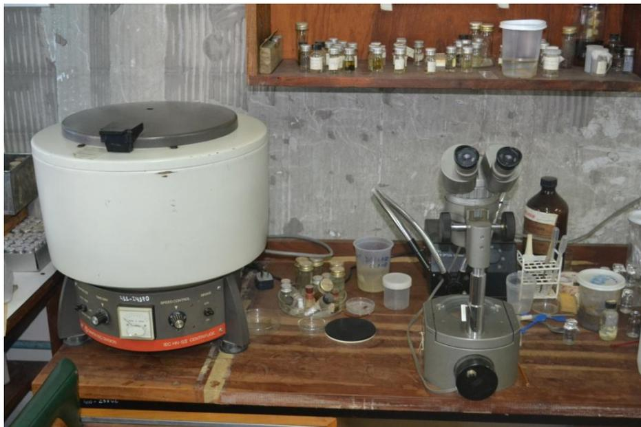
Photo n°15 : Centrifugeuse (7500 tours/minute)
