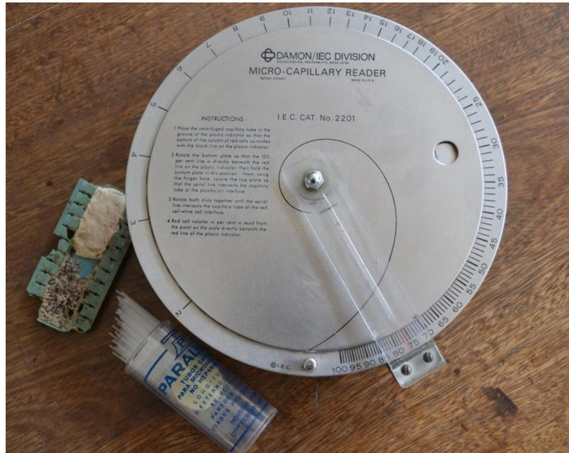
Photo n°14 : Matériel utilisé pour la lecture de l'hématocrite (tubes capillaires et grille de lecture)
